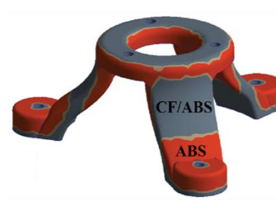
Определение зон для разных материалов
