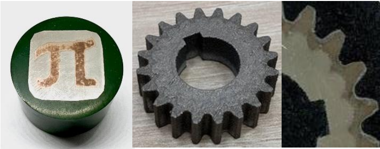
Примеры мультиматериальных изделий, полученных на установке собственной разработки
