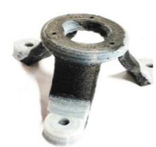
Изготовление изделия с мультиматериальным строением
